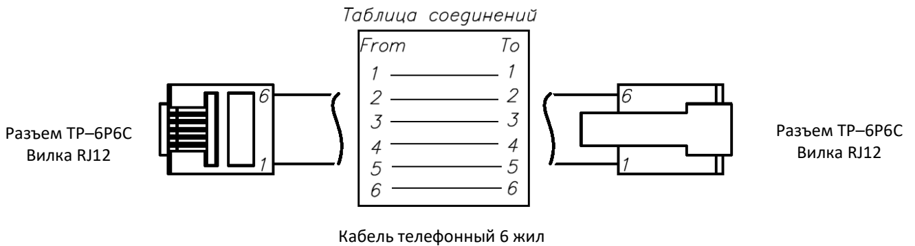
Рисунок 44. Схема кабеля денежного ящика
