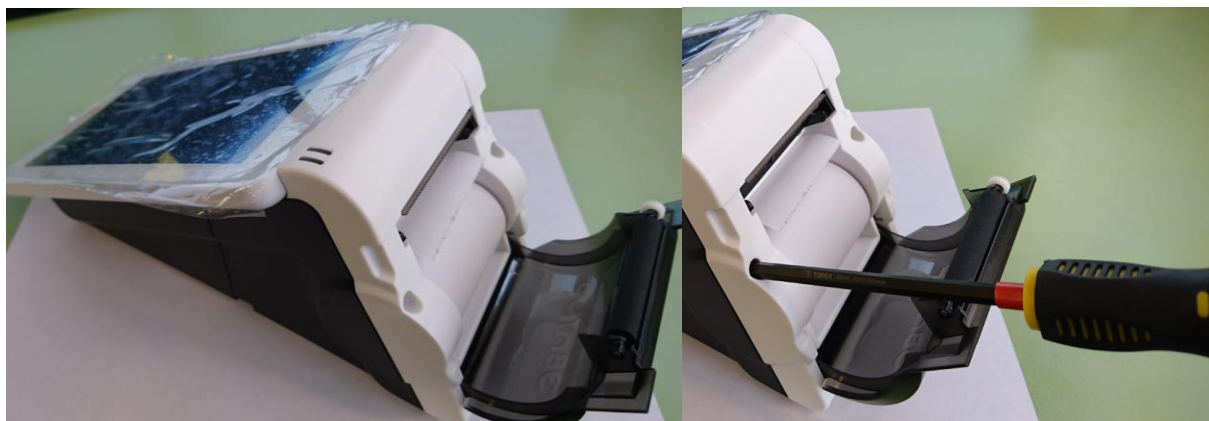
Рисунок 2. Винты крепления корпуса верхнего с корпусом нижним.
