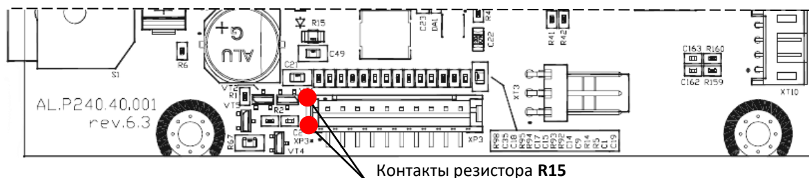
Рисунок 36. Контрольные точки блока управления AL.P240.00.000 rev. 6.3 изделия (верхняя сторона, показана не полностью).
