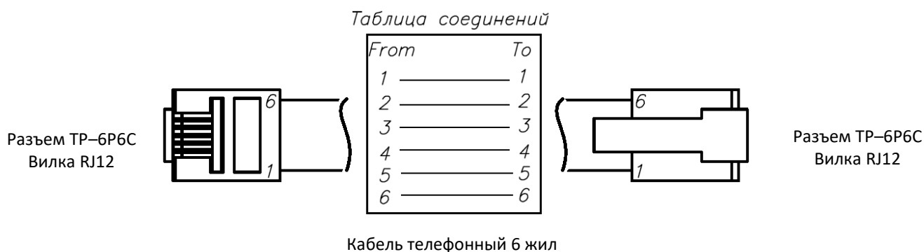
Рисунок 57. Схема кабеля денежного ящика
