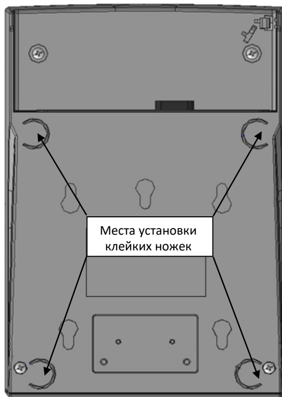
Рисунок 32. Места установка клейких ножек 3M Scotchmate нижней части корпуса изделия
