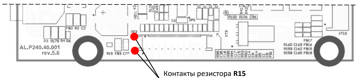
Рисунок 34. Контрольные точки блока управления изделия (верхняя сторона, показана не полностью).
