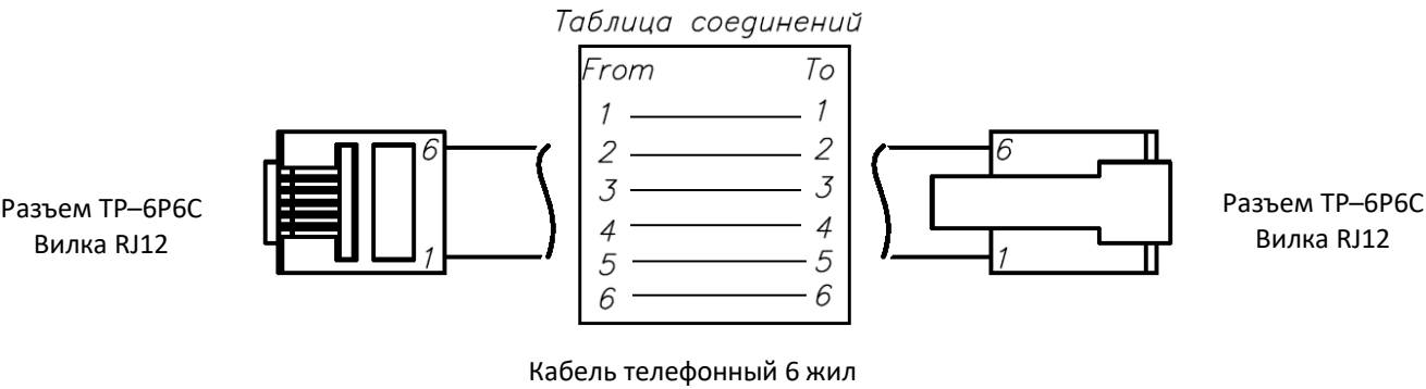
Рисунок 47. Схема кабеля денежного ящика
