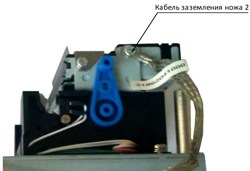
Рисунок 13. Установка кабеля заземления с левой стороны ТПМ
