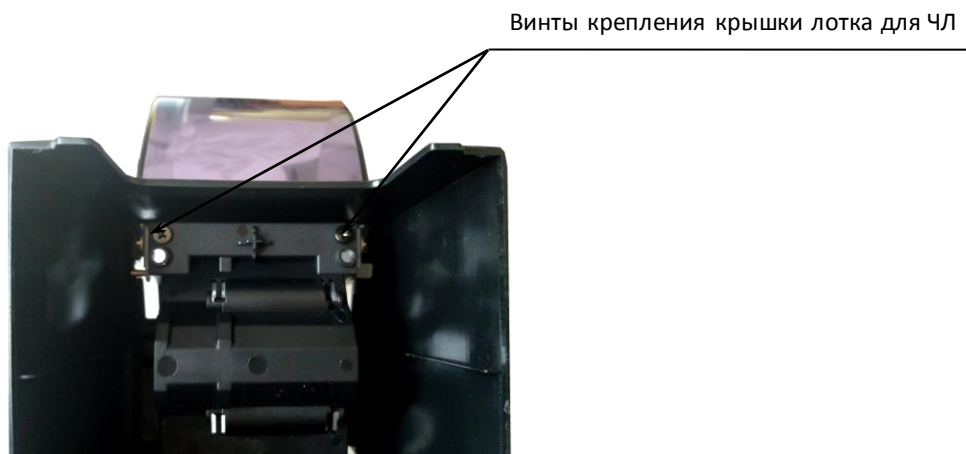
Рисунок 22. Винты крепления крышки лотка для ЧЛ к корпусу ККТ (вид снизу)
