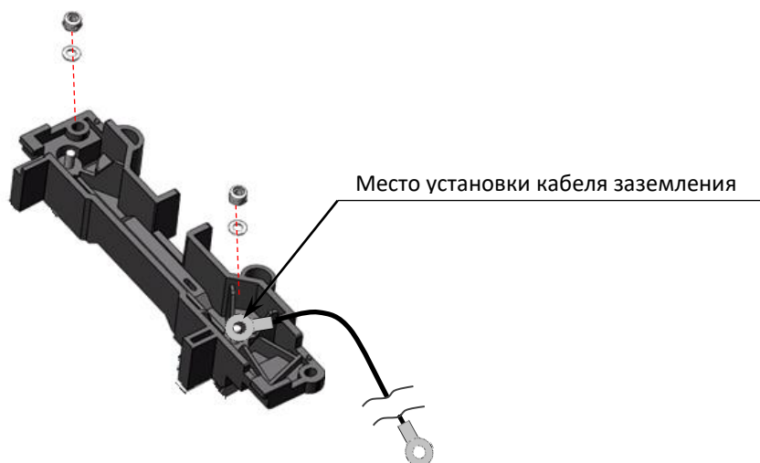
Рисунок 25. Место установки клеммы кабеля заземления с внутренней части основания ТПГ
