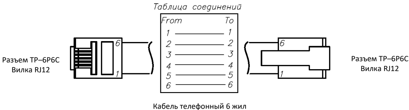
Рисунок 54. Схема кабеля денежного ящика
