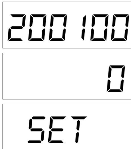
Установите при помощи цифровых клавиш нужное значение в соответствии с таблицами 1 и 2 и нажмите +.
