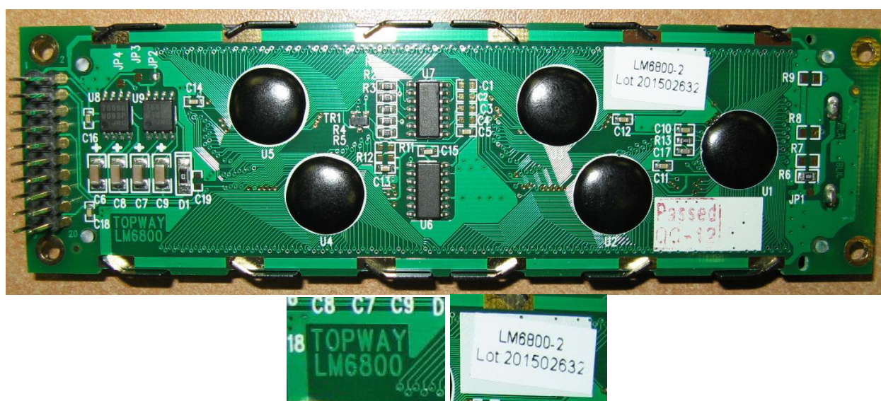
Рисунок 2.18.1 Индикатор LCD-FSTN TOPWAY \ LM6800AGW-2H \ 256x64 Pixel \ LCD FSTN Negative \ белая LED FRZ-035793
